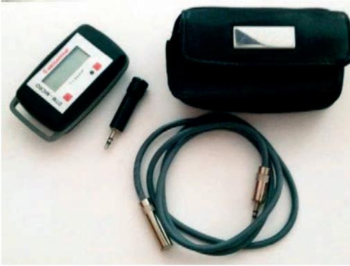
**MEGADYNE DTM MICRO** используется для определения натяжения приводного ремня посредством измерения частоты колебаний неподвижного ремня.
