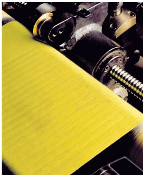
Ремни **MEGAFLAT** – бесконечные бесшовные ремни, изготавливаемые в пресс-формах. Ремни производятся из полиуретана или хлоропренового каучука с усилением полиэстером, арамидом или хлопком.
